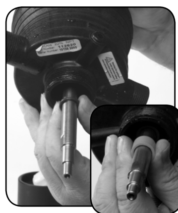
Trin 6. Afmonter og udskift #17 O-RING. Geninstaller #83 PUMPERØRS TÆTNINGSSTYKKE and #15 PUMPERØRSHOLDER.
