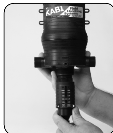
Trin 9. Skrue #7 YDRE CYLINDER på pumpehus.
