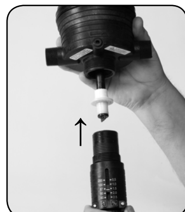
Trin 9. Skrue #7 YDRE CYLINDER på pumpehus.
