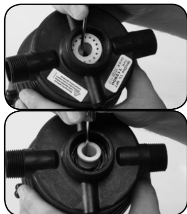
Trin 4. Afmontér og rengør #16 PAKNING og # 82 TÆTNINGSSTYKKE.
