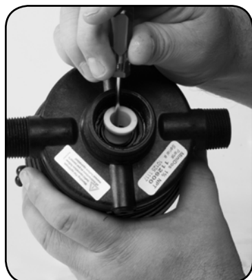
Trin 4. Afmontér #82 TÆTNINGSSTYKKE.
