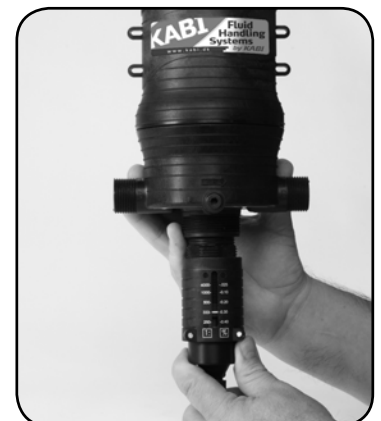
Étape 9. Revisser le CYLINDRE EXTERNE #7 sur le corps de pompe.
