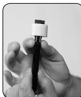
Trin 6. Pres sammen på pumperør og afmonter #44 DOSERINGSSTEMPEL.
