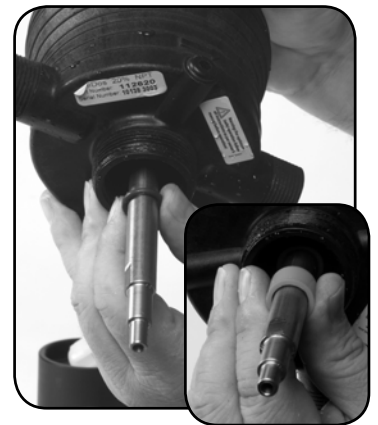
Étape 6. Retirez et remplacez le joint torique n° 17. Réinstallez la RONDELLE DE JOINTURE DE LA TIGE n° 83 et l'ARRÊTOIR DE JOINT n° 15.
