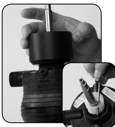
Trin 5. Skrue og fjern #72 ADAPTER, #68 O-RING og #15 PUMPERØRSHOLDER. Rengør og udskift hvis slidt eller beskadiget.
