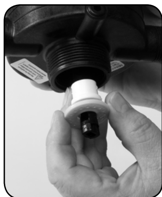
Trin 7. Geninstaller #82 TÆTNINGSSTYKKE og #16 PAKNING.
