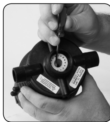
Trin 3. Afmontér #16 PAKNING.
