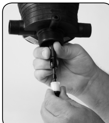
Schritt 8. Installieren Sie den unteren Schaft mit dem neuen Dosierkolben, indem Sie ihn 90° drehen bis er einrastet.
