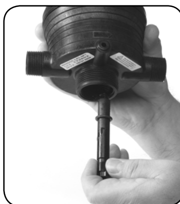
Trin 5. Udskift #17 O-RING.
