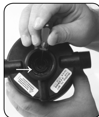
Trin 6. Udskift #17 O-RING.
