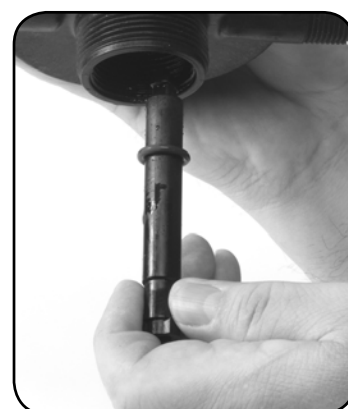
Trin 6. Geninstaller #52 ØVRE PUMPERØR og #17 O-RING.
