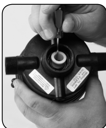
Trin 5. Udskift #83 PUMPERØRS TÆTNINGSSTYKKE.
