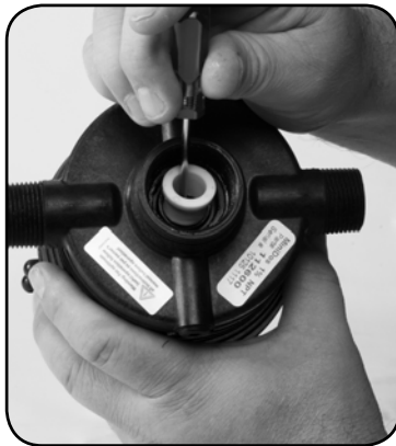
Étape 4. Retirez la RONDELLE DE JOINTURE DE LA TIGE n° 82.
