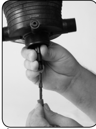
Étape 2. 1/4 tourner à déverrouiller et supprimer # 51 bas arbre et remplacer.
