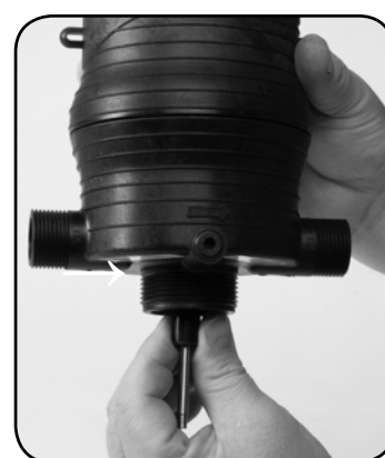
Trin 6. Efter at have udskiftet #82 TÆTNINGSSTYKKE og #18 PAKNING, udskift #52 ØVRE PUMPERØR. Drej 1/4 for at låse.
