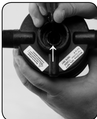
Trin 4. Afmonter #17 O-RING og udskift.
