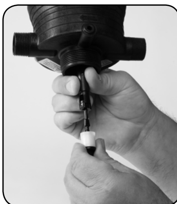
Trin 8. Geninstaller nedre pumperør med nyt doserings stempel ved at dreje 90°, hvilket låser.
