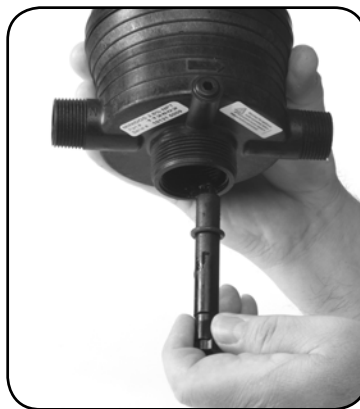
Étape 5. Remplacer le JOINT TORIQUE #17.
