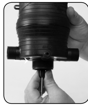
Étape 6. Après avoir remplacé le # 82 sceau espaceur et # 18 joint d'étanchéité, remplacer # 52 arbre supérieure. Tourner à 1/4 de tour pour verrouiller en place.
