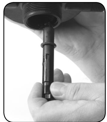
Étape 6. Réinstallez la TIGE DE COMMANDE #52, le JOINT TORIQUE #17.
