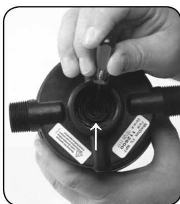
Trin 5. Afmontér #17 O-RING og udskift.
