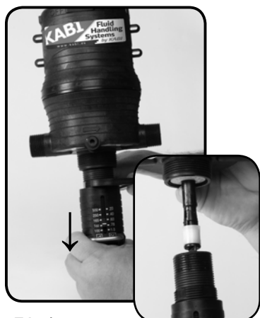
Trin 1. Skrue #7 YDRE CYLINDER fra pumpehus.
