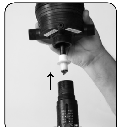
Étape 9. Revissier le CYLINDRE EXTERNE #7 sur le corps de pompe.
