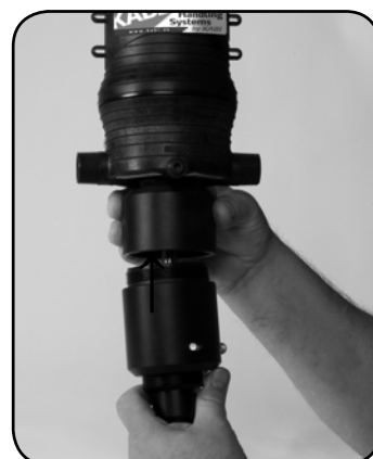
Trin 9. Skrue #61 YDRE CYLINDER på pumpehus.
