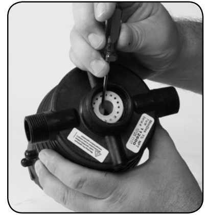
Schritt 3. Remove #16 Gasket.
