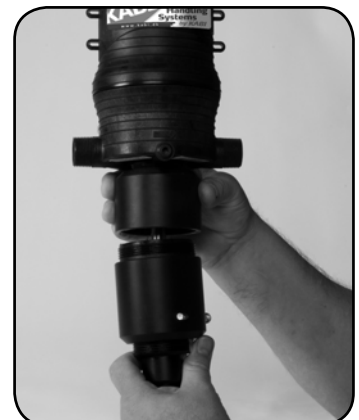
Étape 9. Vissez le CYLINDRE EXTÉRIEUR n° 61 sur le corps.
