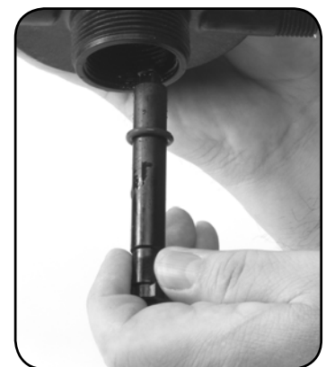
Schritt 6. Installieren Sie wieder den UNTEREN SCHAFT #52 und O-ring #17.
