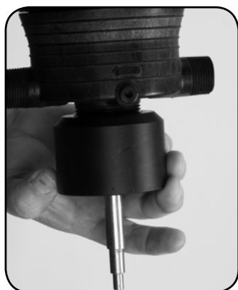
Trin 7. Nulstil #68 O-RING og skru #72 ADAPTER på pumpehus.
