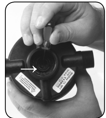
Étape 6. Remplacez le joint torique n° 17.
